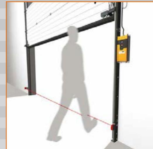
auf der Seite des Steuerungsteils, auf der gegenüberliegenden Laufschiene befindet sich ein Reflektor oder Empfänger. Wenn der Strahl zwischen dem Sender und dem Reflektor / Empfänger unterbrochen wird, erhält der Antrieb ein Signal, das ihn stoppt und die Bewegung umkehrt. Die Version mit Reflektor ist störanfällig bei Staub und Feuchtigkeit, bei der Version mit Empfänger ist das kein Problem.
